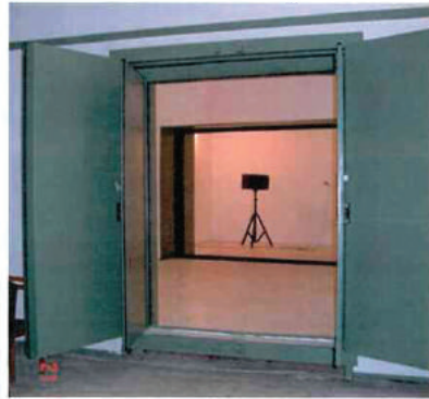
Şekil 3: Ses Geçiş Kaybı Test Odalarından fotoğraflar
